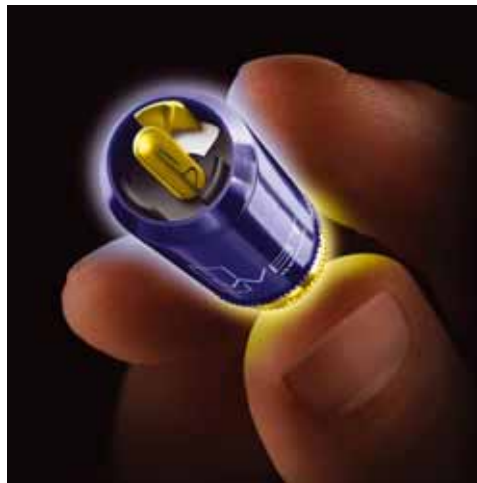
Deutlich zu sehen: Anstelle des üblichen, ringförmigen äußeren Kontakts übernimmt ein einzelner Stift die Masseverbindung
